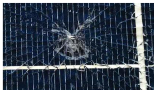
台風による飛散物で破損したパネル
