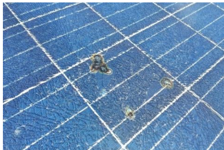
写真 6-6 ホットスポット モジュール表面
